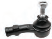
FO1028 Outer Tie Rod End (Ø11.5*Ø13.8/M14*2)
