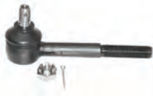
TO1026 Outer Tie Rod End (Ø14.6*Ø16/M17*1.5)
